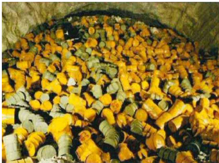
Abb. 3: Sturzkammer mit schwachradioaktiven Abfällen; ELK 2/750.
