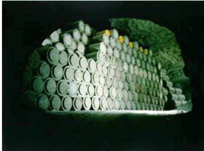
Abb. 2: Einlagerungskammer mit gestapelten VBA und 200 I-Fässern (LAW); ELK 7/750.
