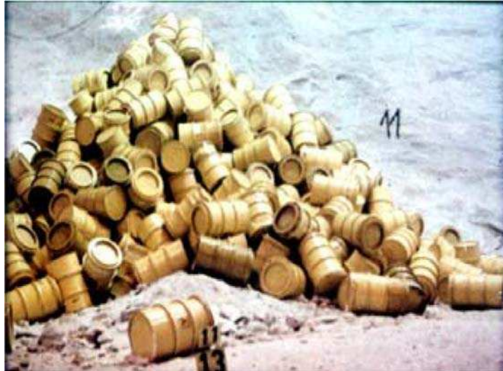
Abb. 4: Einlagerungskammer 8a/511 mit mittelradioaktiven Abfällen.
